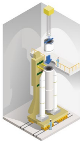
Intégration de l'étage supérieur et du cerveau électronique.
